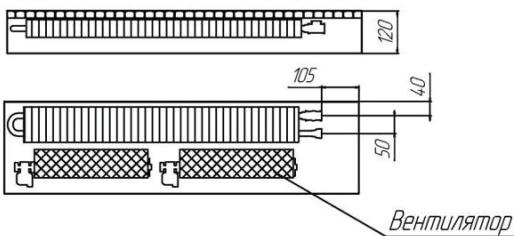
**Конвектор Бриз В шириной 380 (вид сверху)**
